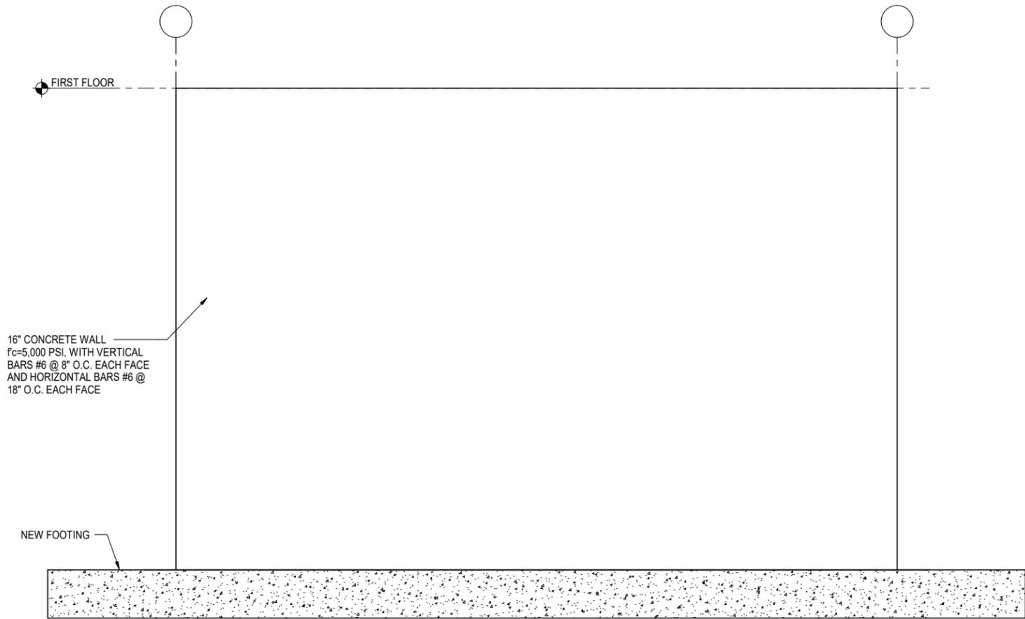
**1 TYPICAL CONCRETE SHEAR WALL ELEVATION**
